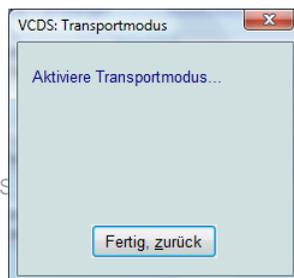
verschiedene Fahrzeugsysteme zentral in den Transportmodus versetzt, dies ist zum Beispiel vor längerer Standzeit bzw. Transport des Fahrzeuges sinnvoll bzw. notwendig um die Batterie zu schonen.
