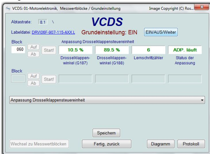
Sofern Sie die aktuellen Werte der Grundeinstellung dem Sitzungsprotokoll hinzufügen wollen können Sie dies über die Schaltfläche [ **Speichern** ] tun. Die Schaltfläche [ **Wechsel zu Messwertblöcken** ] ermöglicht es Ihnen zwischen Grundeinstellung und Messwertblöcken zu wechseln (nur für Steuergeräte mit KWP-1281).
