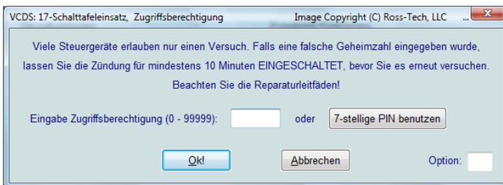
Nach bestätigen des eingegebenen Wertes mittels [ **Ok** ] erhalten Sie vom Fahrzeugsystem eine Rückmeldung, sollte der von Ihnen gewählte Wert nicht plausibel sein oder ein anderes Problem vorliegen erhalten Sie eine entsprechende Fehlermeldung. In beiden Fällen wie auch nach dem Betätigen der Schaltfläche [ **Abbrechen** ] kehren Sie zur Steuergerät Identifikation und Funktionsübersicht zurück.
