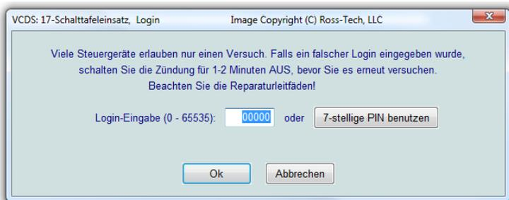
Die Benennung der Funktion 11 unterscheidet sich je nach genutztem Kommunikationsprotokoll zwischen Login (KWP-1281) und Codierung-2 (KWP-2000/6000), die Handhabung der Funktion ändert sich jedoch kaum.
