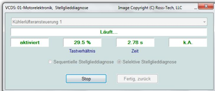
Die Funktion selektive Stellglieddiagnose ist ausschließlich verfügbar wenn seitens **VCDS** eine Dokumentation für das Steuergerät verfügbar ist.
