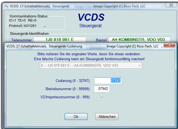
Im Fall des gezeigten Steuergerätes setzt sich die Codierung aus 5 Stellen zusammen welche in der eingeblendeten Codiertabelle aufgeschlüsselt werden. Die einzelnen/relevanten Stellen werden hierbei mittels Fragezeichen hervorgehoben. So stehen die 4. und 5. Stelle (von rechts) für die Ausstattung des Fahrzeuges, die gezeigten Werte sind zu addieren (siehe Vorzeichen) um den endgültigen Wert für diese beiden Stellen zu erhalten.
