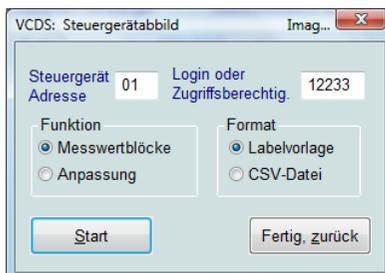
eingetragen werden, der vor Abfrage der Daten an das Steuergerät gesendet wird um z.B. weitere Messwertblöcke oder Anpassungskanäle freizuschalten.
