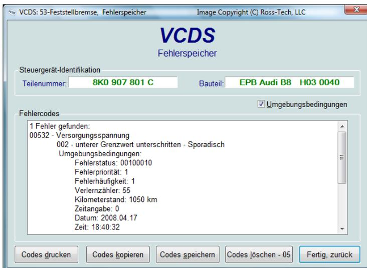
Moderne Steuergeräte unterstützen außerdem **Umgebungsbedingungen** (siehe [Abschnitt 3.2.3.2](#)) ebenso wie der Status einer ggf. verbauten Warnleuchte des betreffenden Fahrzeugsystems (z.B. Motor, ABS Warnleuchten).
