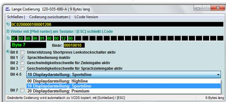
Der Bildschirmaufbau gliedert sich in 4 Bereiche. Unter **[ 1 ]** wird die aktuelle Codierung des Steuergerätes automatisch angezeigt, diese kann auch manuell eingefügt werden z.B. wenn das Plugin separat (Offline) gestartet wird.
