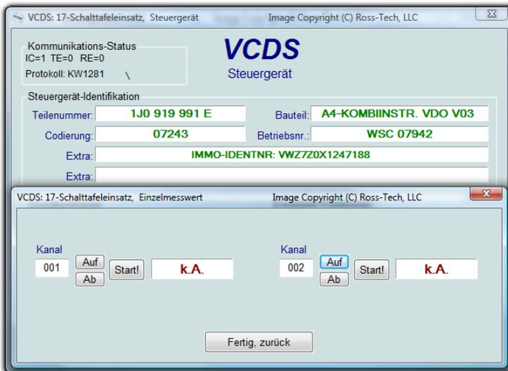
Die einzelnen Werte/Kanäle können Sie wie auch im Falle der normalen Messwertblöcke über die [ **Auf** ] bzw. [ **Ab** ] Schaltflächen anwählen oder auch direkt in das Feld **Kanal** eingeben.
