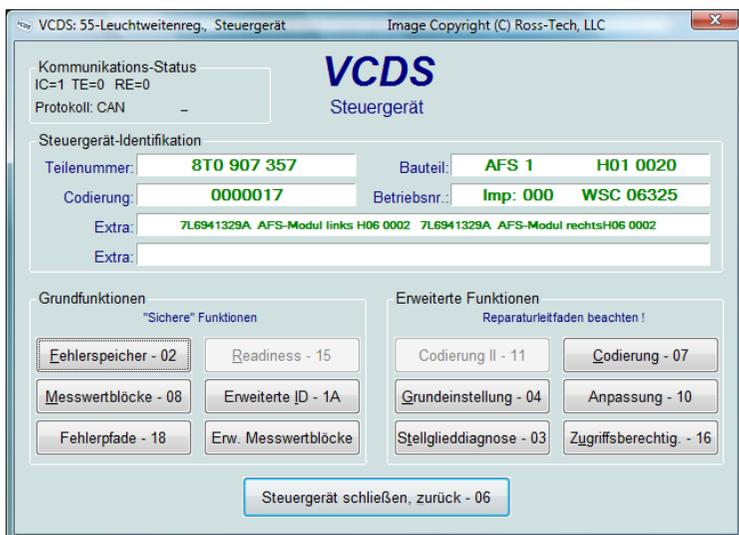
Das Feld Kommunikationsstatus gibt Auskunft zur Datenübertragung mit dem angewählten Steuergerät. Neben dem verwendeten Protokoll werden zusätzlich Informationen zur Verbindung aufgezeigt.
